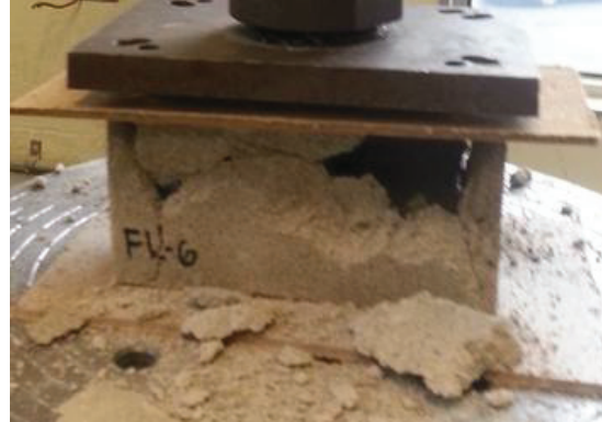
(d) FL-6: Conical Shear Failure
