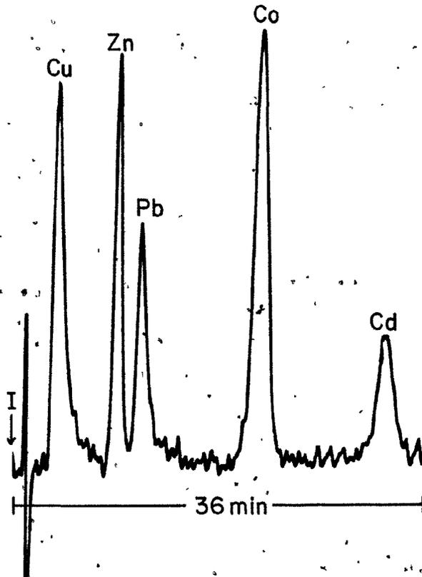
Fig. 3-1: Isocratic A-9/ $\text{NH}_4$ -tart. separation
