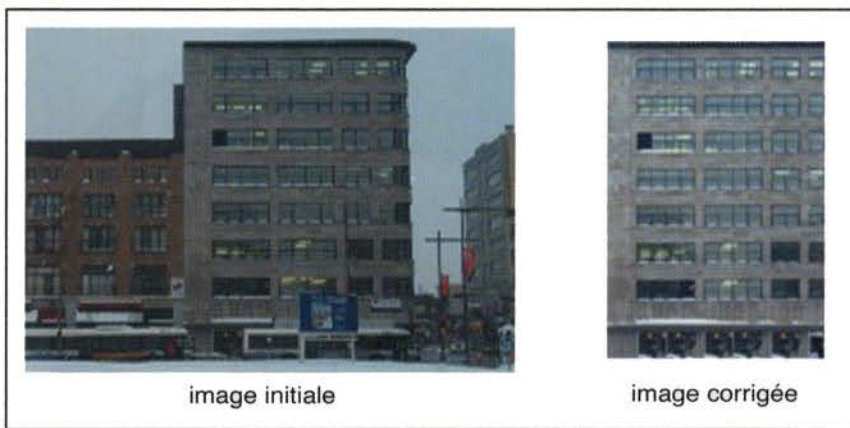
III. 2. Correction des images. L'autobus et l'écrêteau se trouvant en avant-plan ont été enlevés et les fuyantes verticales ont été redressées.
